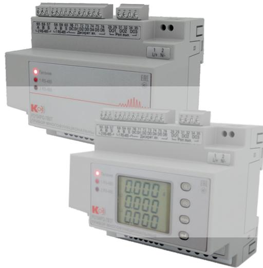
Многофункциональные цифровые электроизмерительные приборы PD194PQ торговой марки КС® предназначены для измерения электрических параметров в трехфазных сетях переменного тока, выполнения функций телеизмерений, телесигнализации и телеуправления. Используются в системах телемеханики, АСУ ТП, АИИС подстанций и электростанций.
